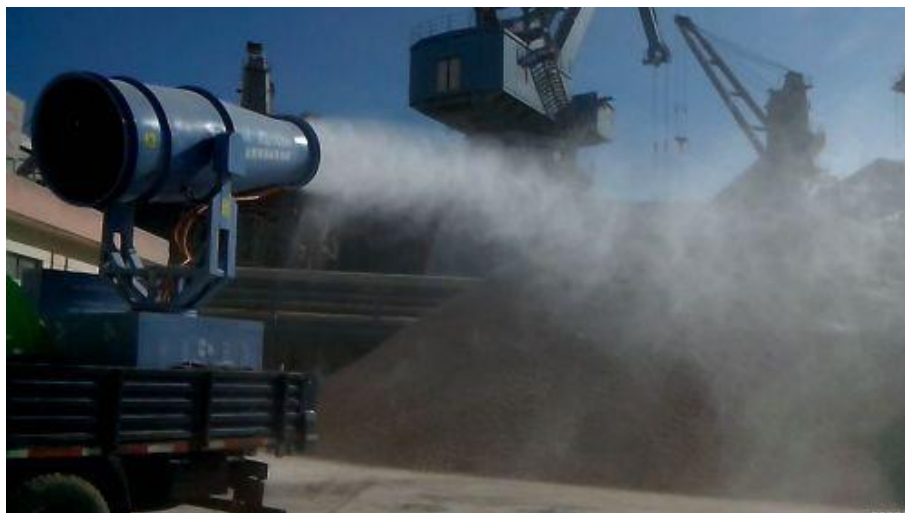
图 4.3-1 移动式喷雾除尘设备
