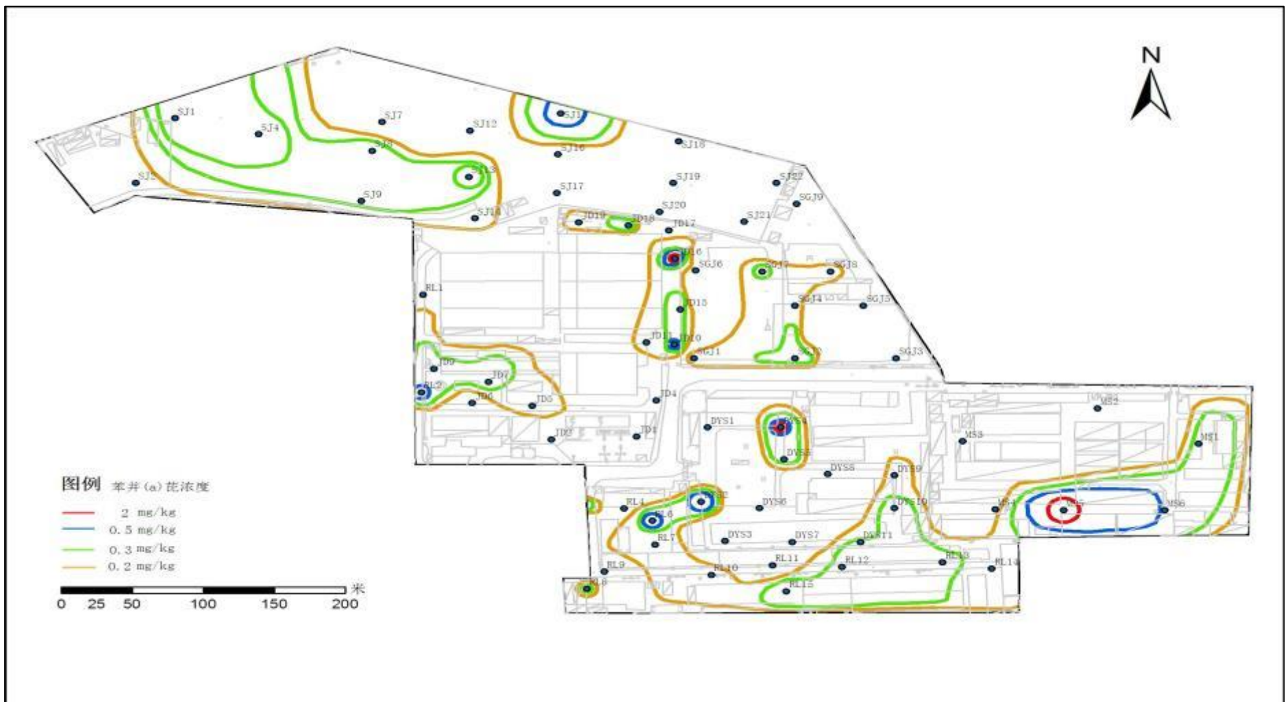
图 4.2-13 埋深 0-1m 范围内土壤样品中苯并(a)芘浓度分布示意图
