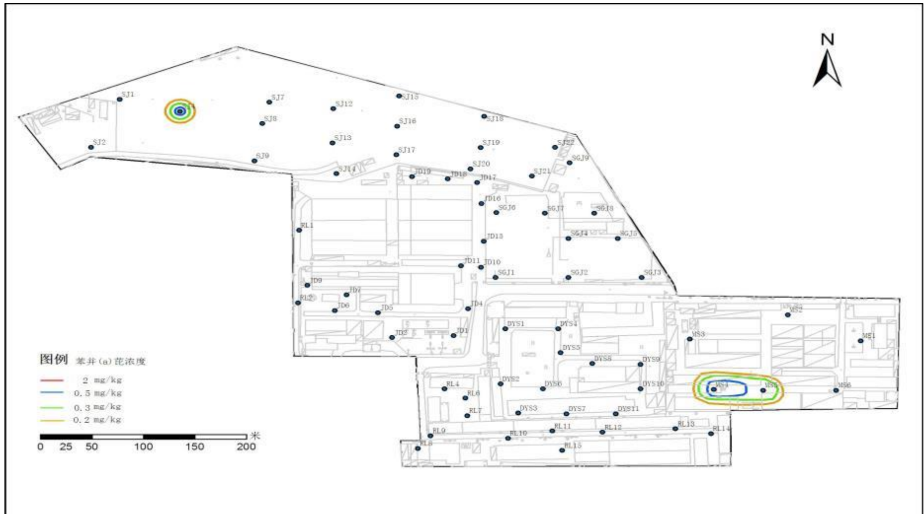
图 4.2-18 埋深 5-6m 范围内土壤样品中苯并(a)芘浓度分布示意图
