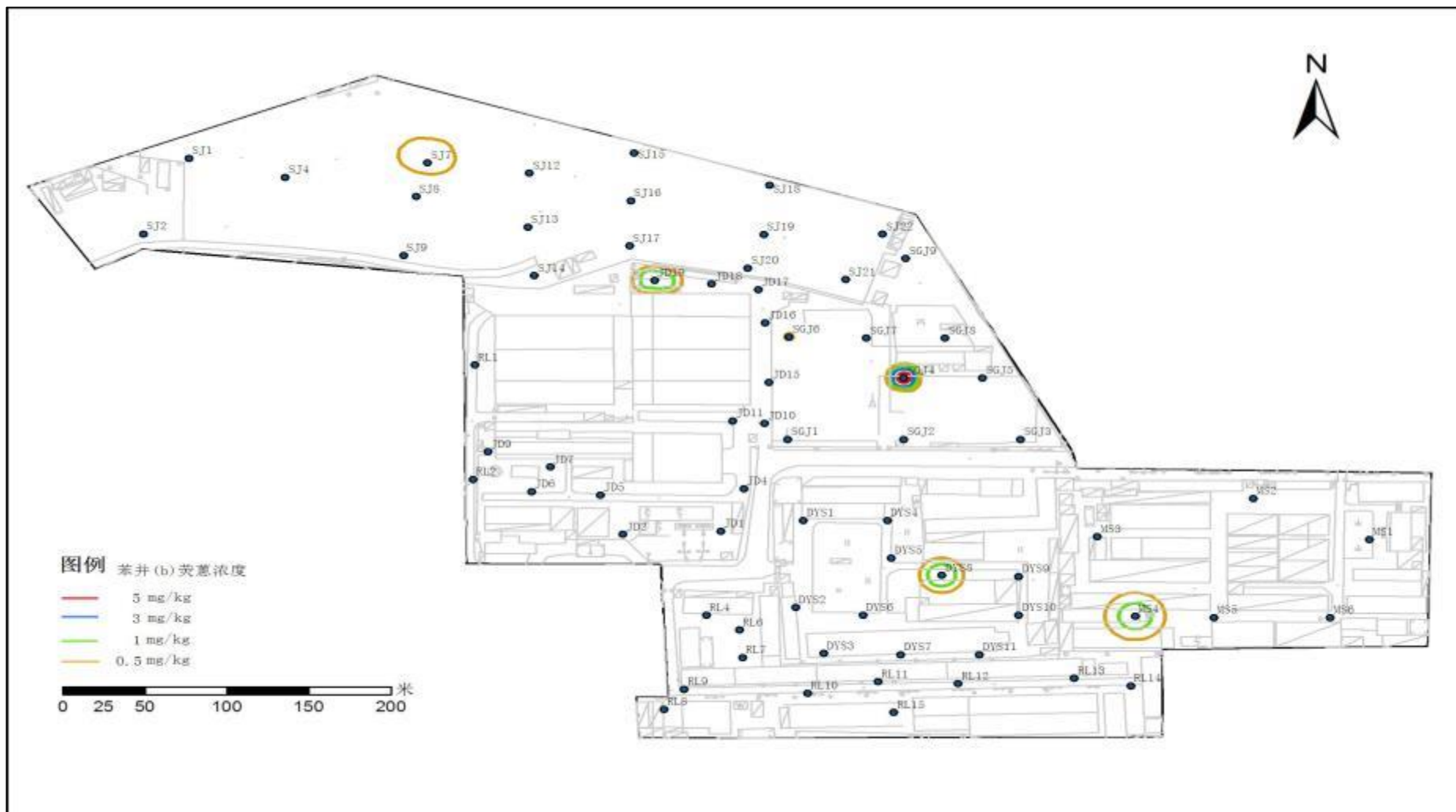
图 4.2-27 埋深 2-3m 范围内土壤样品中苯并(b)荧蒽浓度分布示意图
