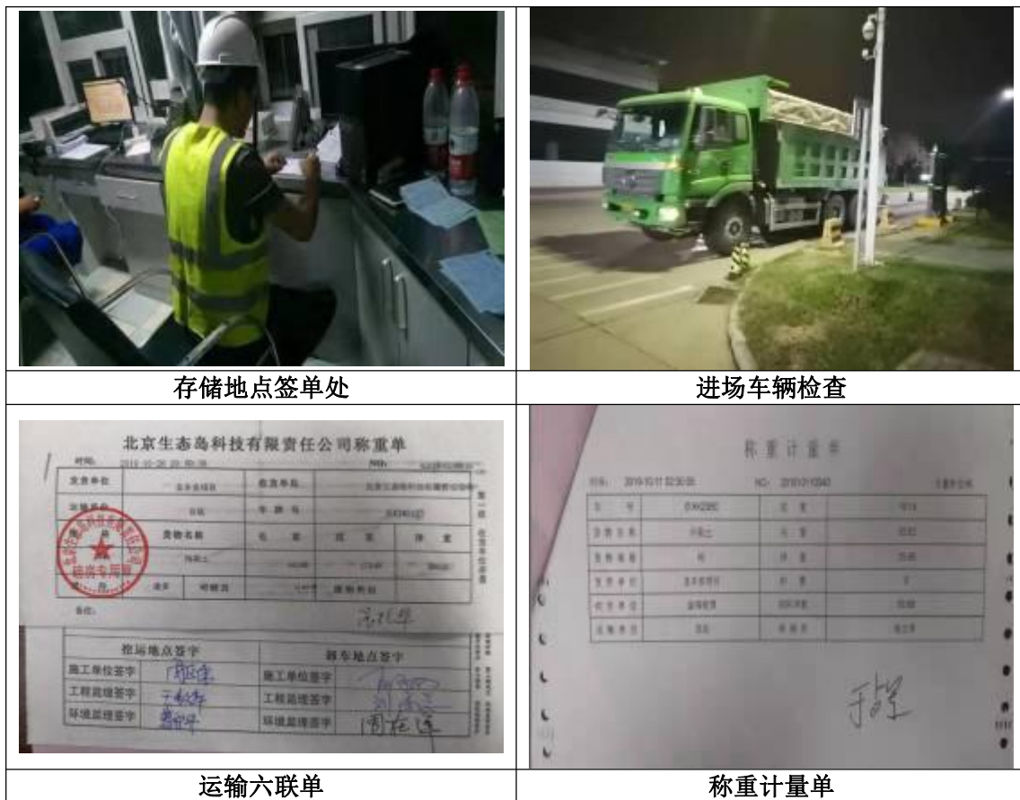
图 3.4-11 存储地点签单处、进场车辆检查、运输六联单及称重计量单
