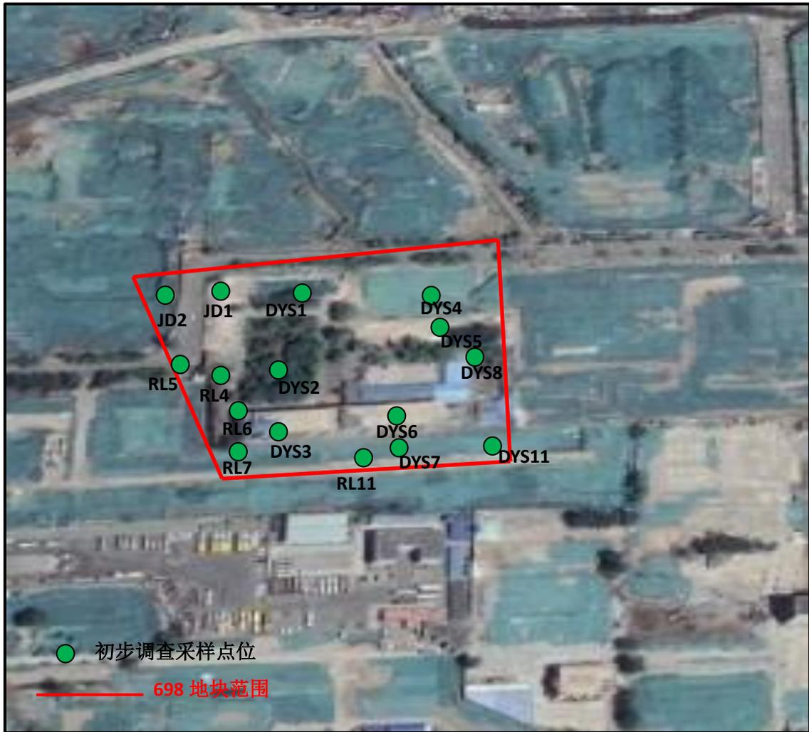
图 3.1-1 场地初步调查土壤钻孔位置示意图
