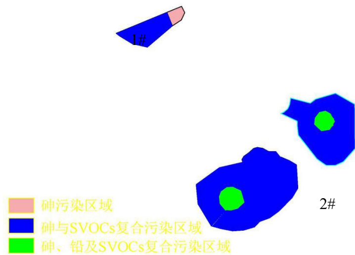
图 4.2-3 694-1 地块含重金属污染区域清挖图
