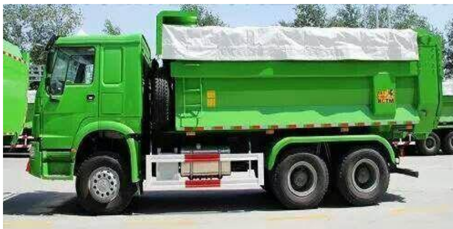
图 2.1-1 污染土运输车辆覆盖
