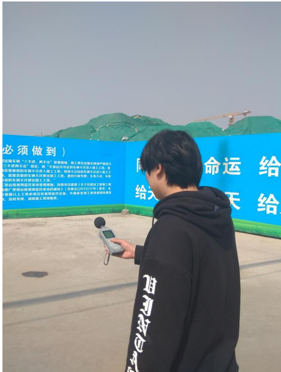
图 6.3-2 清挖现场噪声监测图
