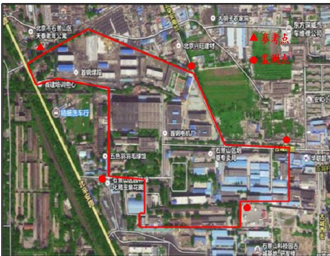
图 4.6-1 清挖现场空气监测布点图
