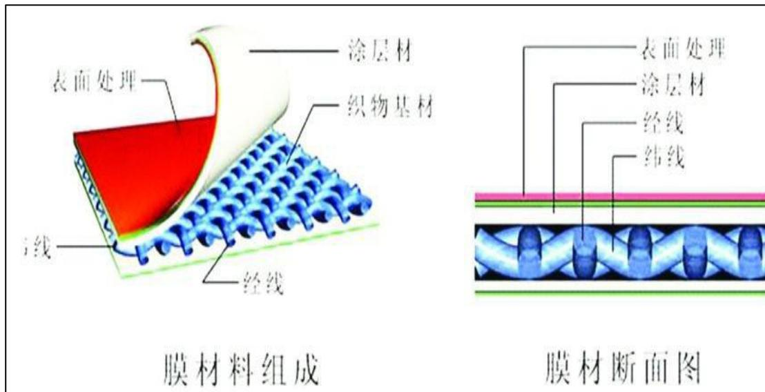
图 4-4 膜材结构组成图
