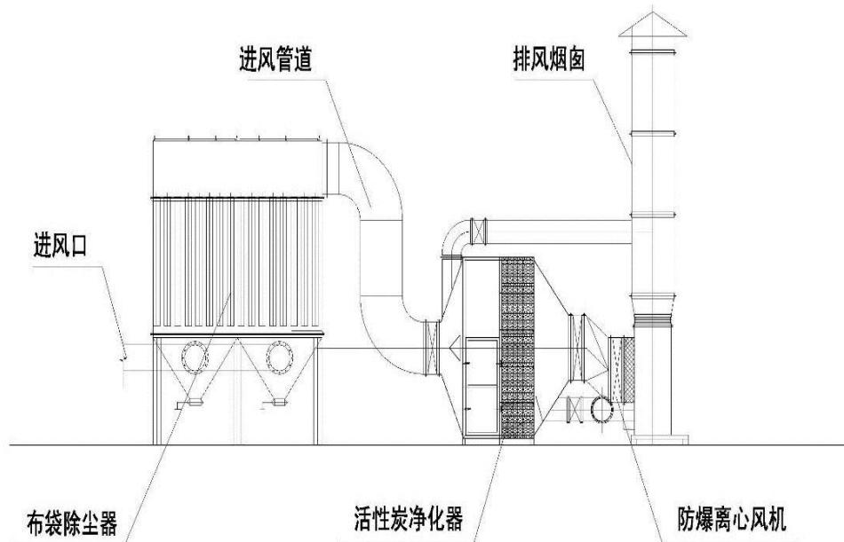
图 7-11 尾气体处理系统工艺图
