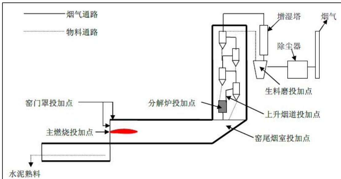
图 7-13 水泥窑协同处置固体废物投加点示意图
