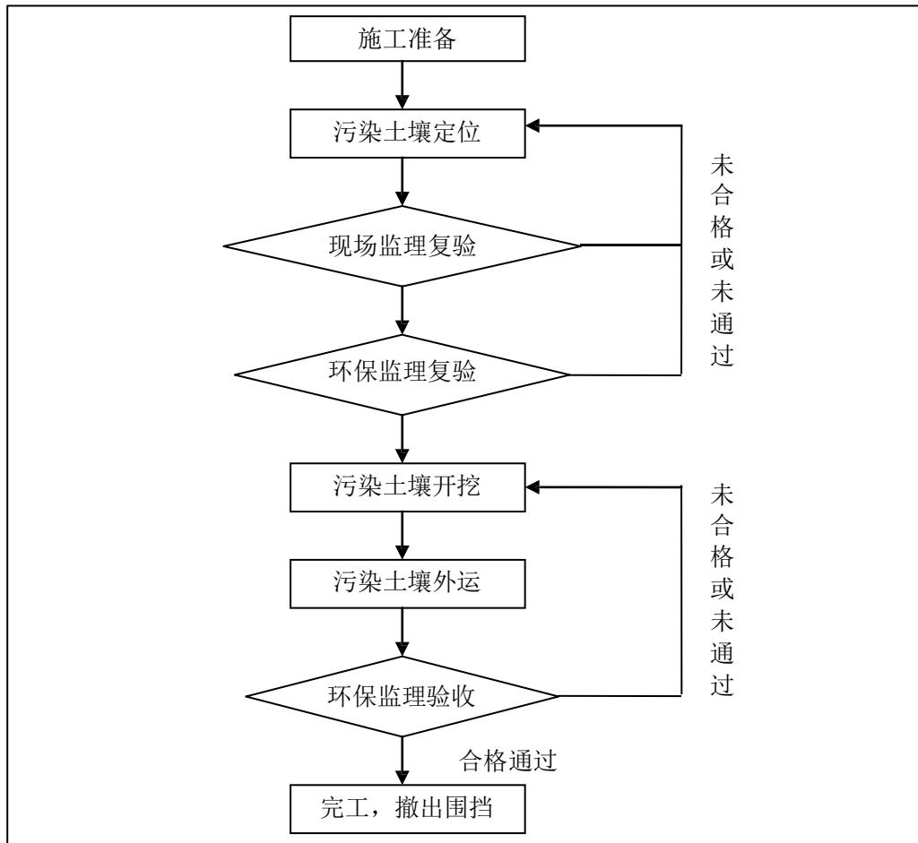
图 6-2 污染土壤现场清理及运输工艺流程
