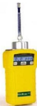
图9-8 便携式挥发性气体检测仪（PID）
