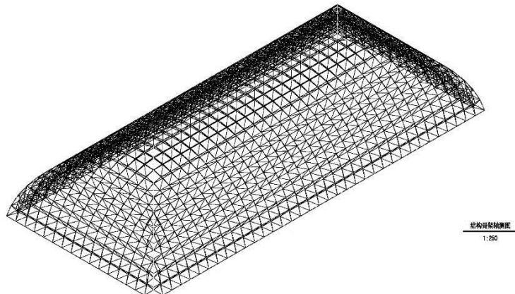
图 7-5 负压大棚膜结构轴测图
