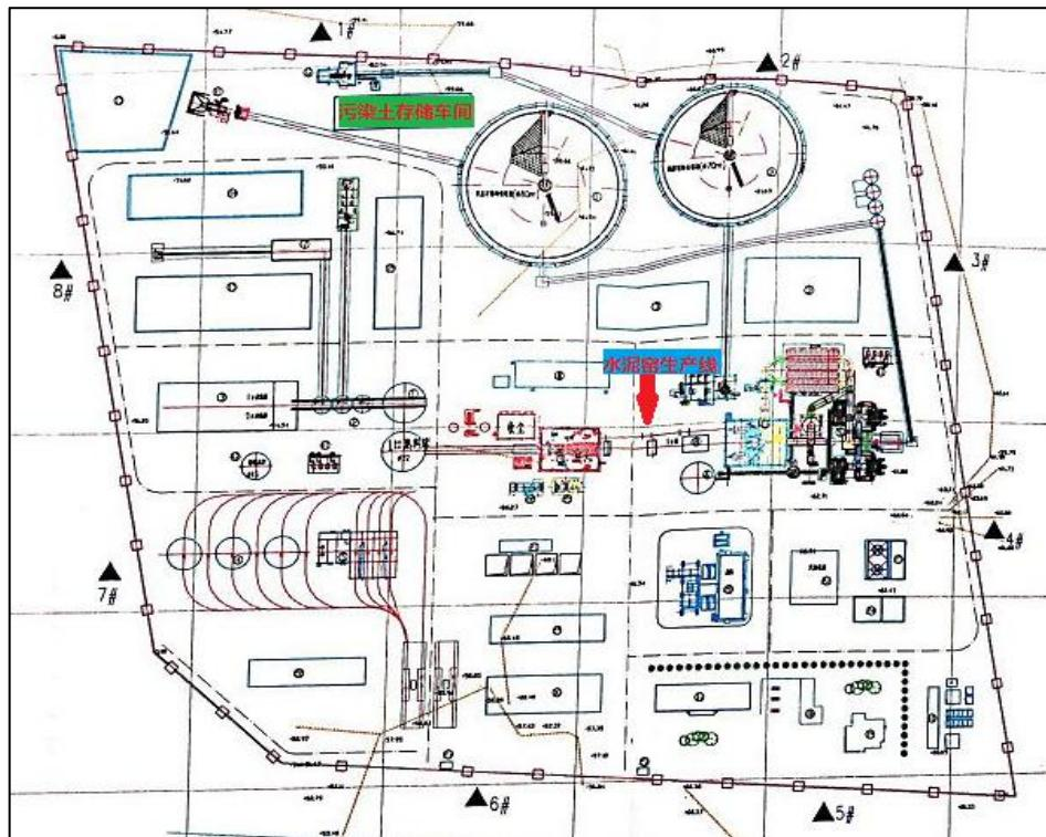
图 5-3 污染土壤异位修复区域平面布置图
