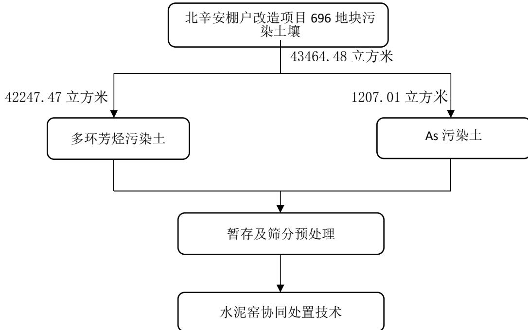
图 4-1 土壤修复技术路线
