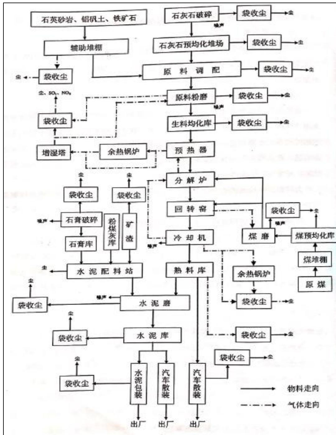
图 7-13 水泥窑协同处置技术工艺流程图
