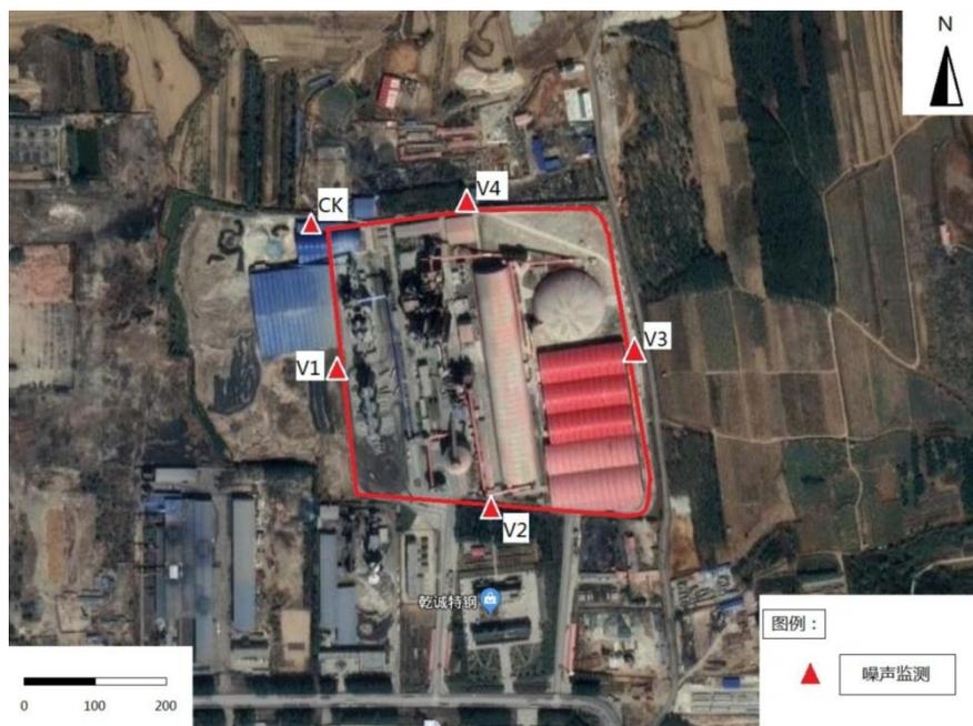
图 9-14 水泥窑协同处置区域厂界噪声监测布点图
