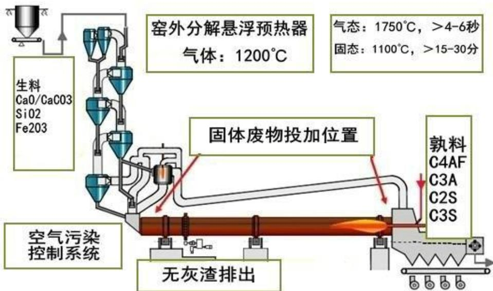
图 3-3 水泥窑协同处置技术工艺示意图
