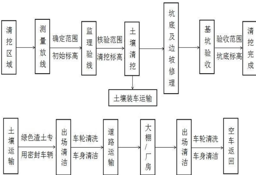
图 6-1 污染土清挖、运输流程示意图
