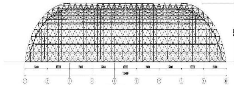
图 7-3 负压大棚膜结构立面图
