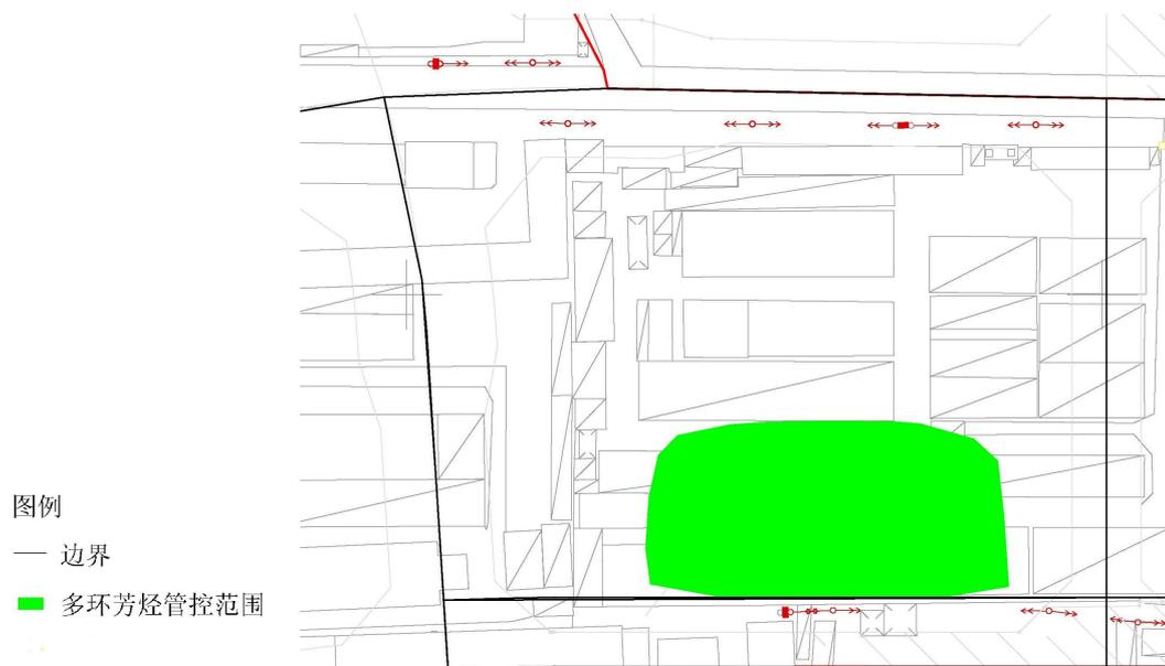
图 1-17 污染土壤第五层(4-5m)修复范围示意图
