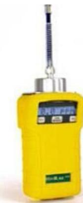
图 9-13 便携式挥发性气体检测仪（PID）
