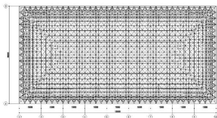
图 7-2 负压大棚膜结构平面图
