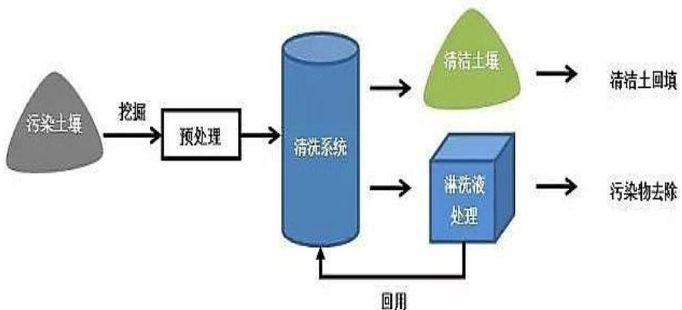
图 3-6 异位淋洗技术流程
