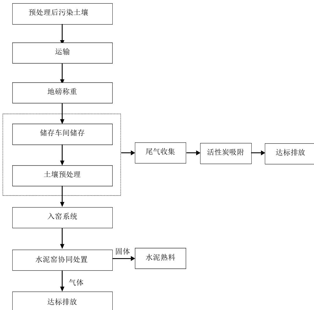
图 7-12 水泥窑协同处置污染土壤工序流程图
