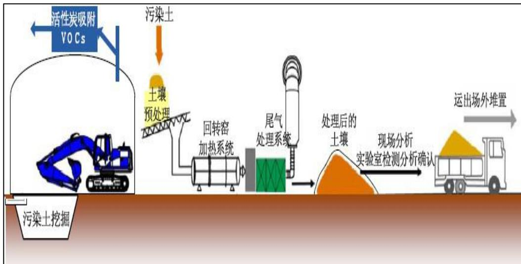
图 3-5 热脱附技术工艺流程
