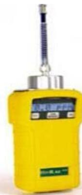
**图 9-4 便携式挥发性气体检测仪（PID）**
