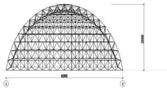
图 7-4 负压大棚膜结构侧立面图
