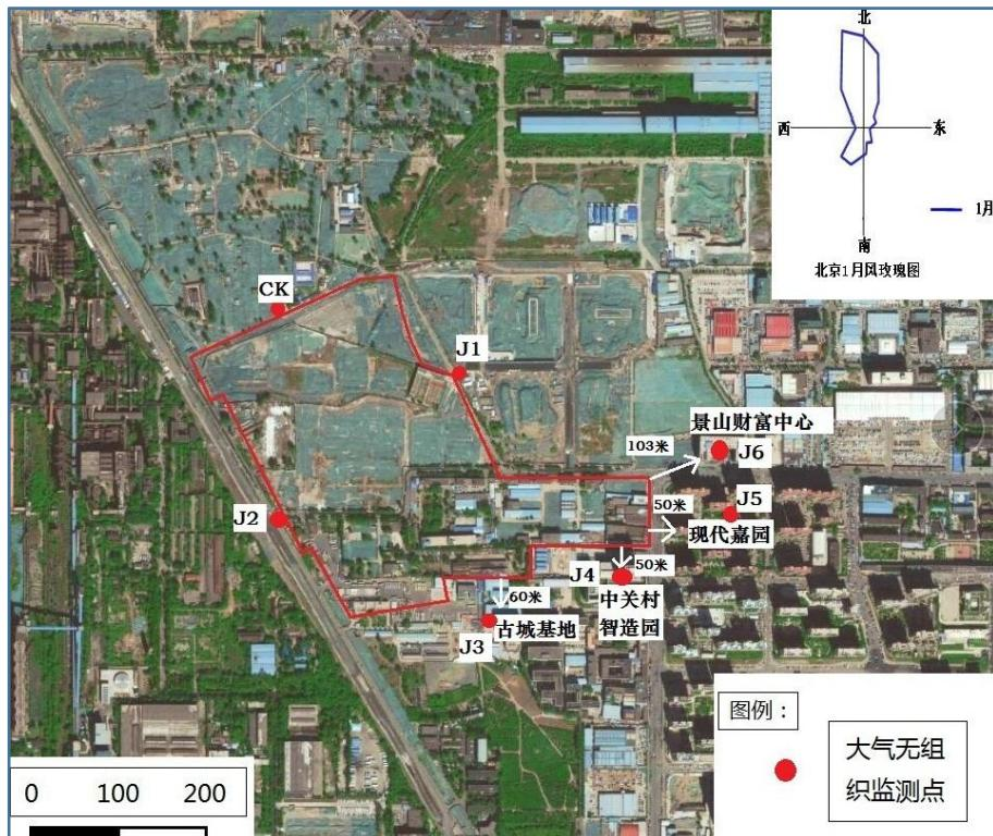
图 9-3 清挖现场大气监测点布置示意图
