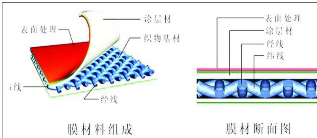
图 7-6 膜材结构组成图
