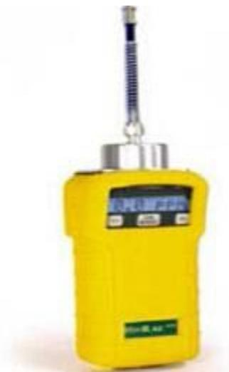
图 9-8 便携式挥发性气体检测仪（PID）
