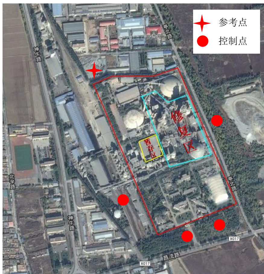
图 6.3-1 北京水泥厂空气监测布点图
