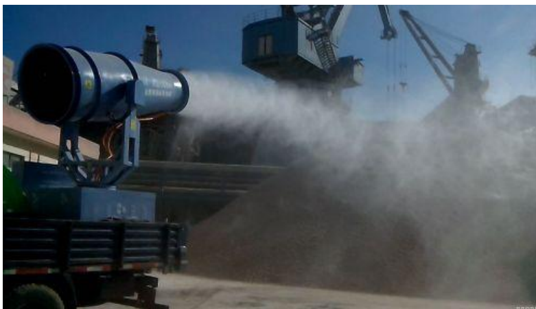
图 4.2-11 移动式喷雾除尘设备
