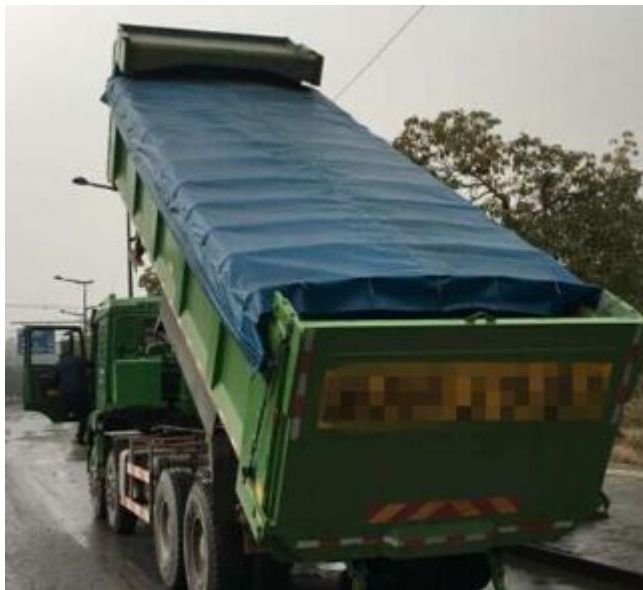
图 2.1-2 污染土运输车辆覆盖
