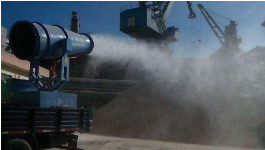
图 4.3-1 移动式喷雾除尘设备
