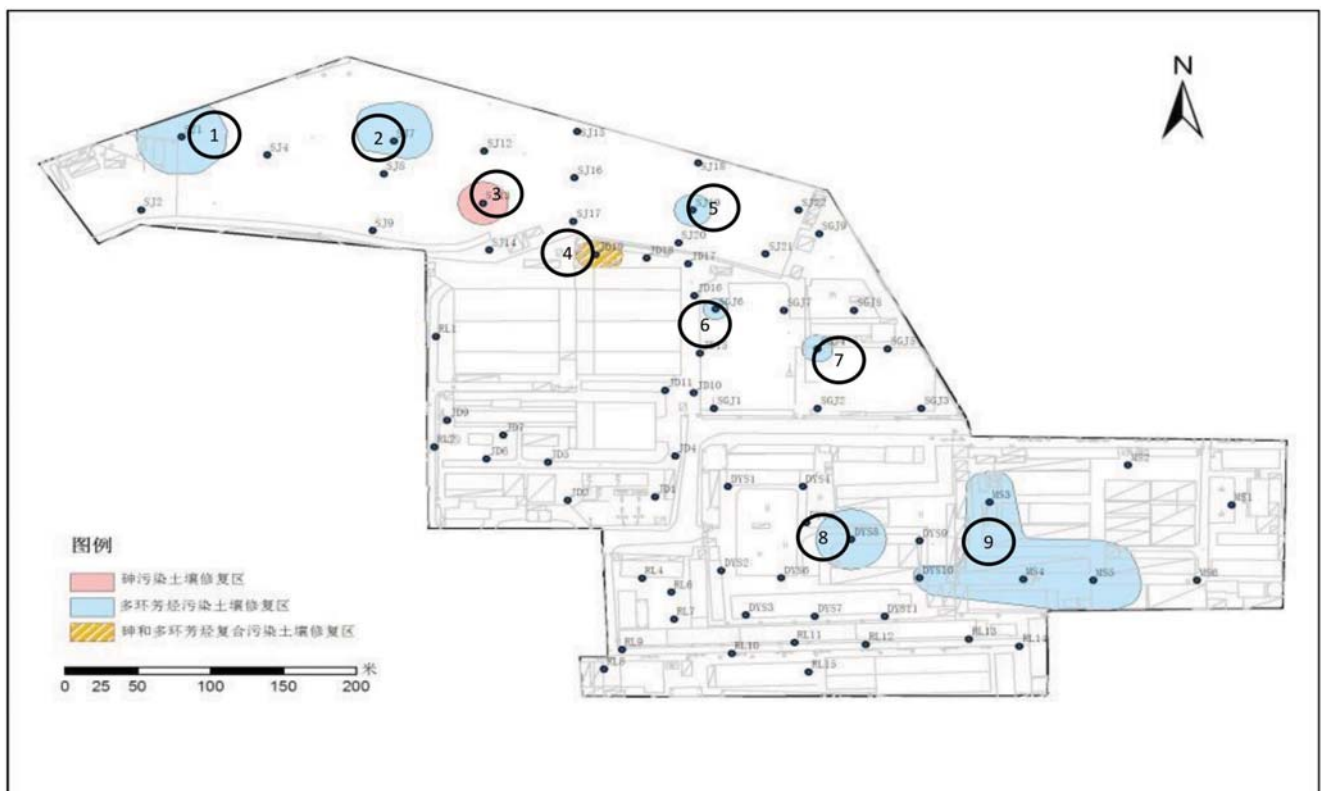
图 1.4-3 污染土壤第三层(2-3m)修复范围示意图
