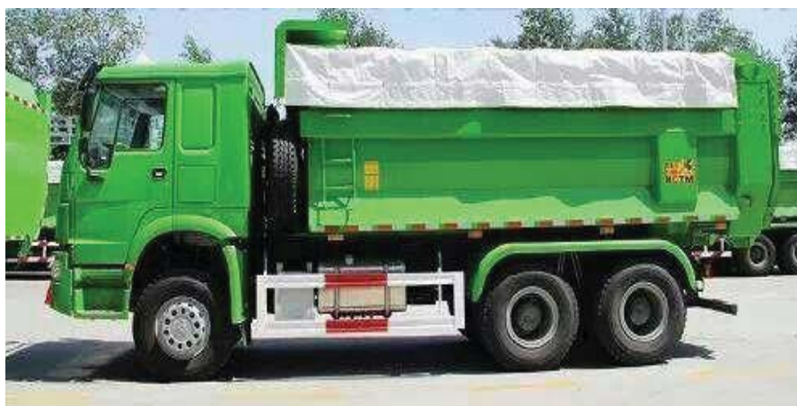
图 2.1-3 污染土运输车辆覆盖
