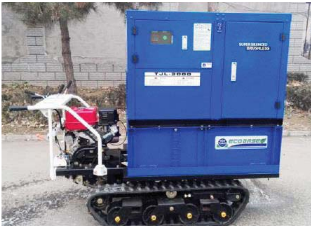
图 2.1-2 气味抑制剂 FD2 喷洒系统
