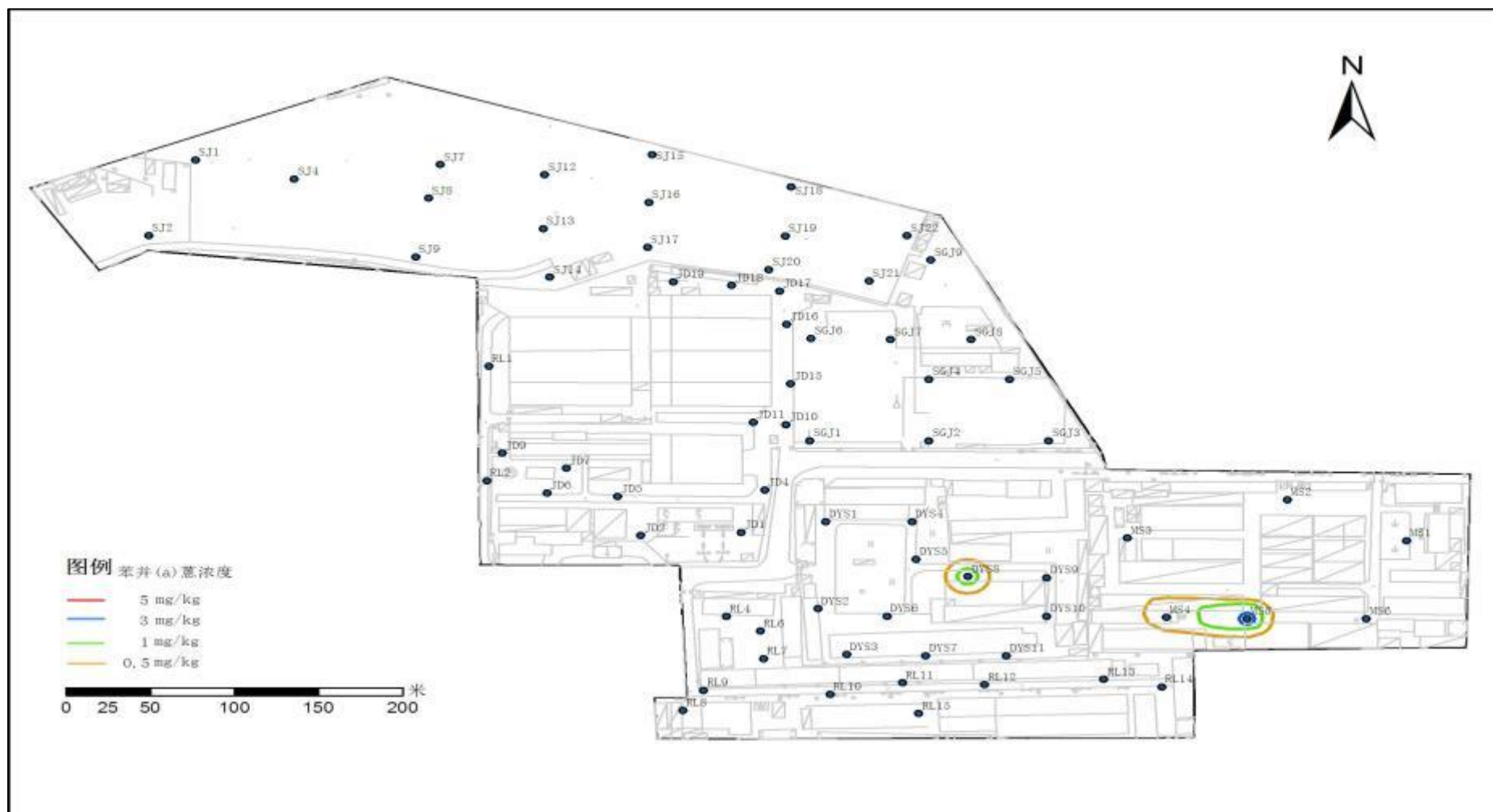
图 4.2-22 埋深 3-4m 范围内土壤样品中苯并(a)萘浓度分布示意图
