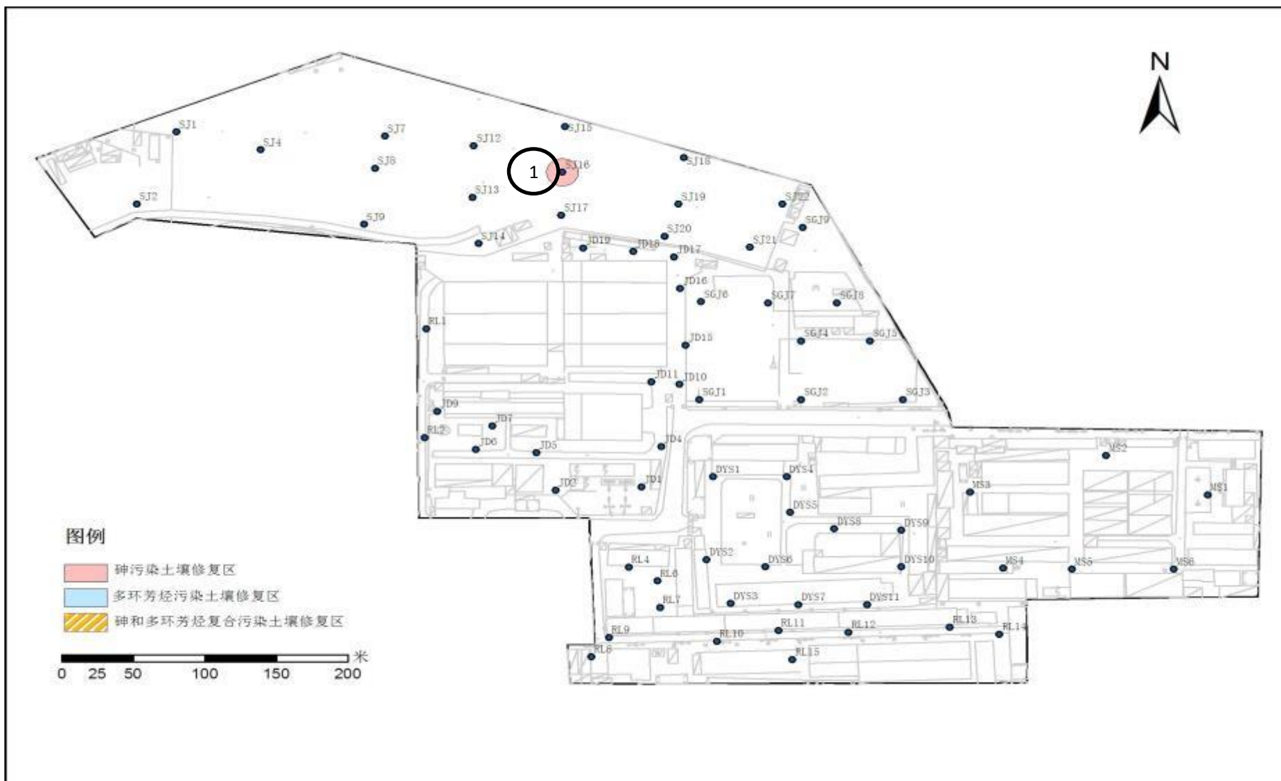
图 6.2-6 污染土壤第六层(5-6m)修复范围示意图
