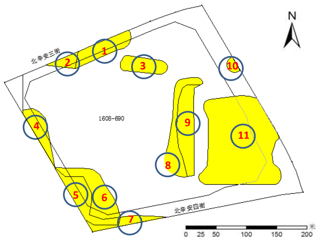
图 8.2-1 污染土第一层 (0-1m) 修复示意图
